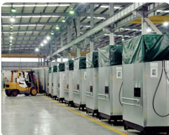
Изготовление и сборка санитарного модуля в заводских условиях гарантирует стабильность качества изделия
